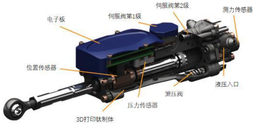
图表 12 电液驱动关节结构示意图
