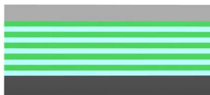
3 沉积沟道刻蚀用的硬掩模，通常选择具有高耐蚀刻性的无定形碳膜。刻蚀气体以O<sub>2</sub>为主，辅以N<sub>2</sub>和H<sub>2</sub>。
