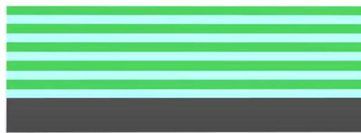
2 采用CVD交替沉积多层薄膜直至所需层数。常见两种搭配是氧化物-氮化物和氧化物-多晶硅，比如三星选择的是氮化硅和二氧化硅。多层沉积的难点在于保证高堆叠层的精确厚度和良好均匀性。
