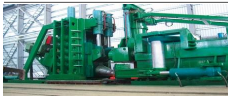
图：贵阳工厂4500mm精密数控辗环机
