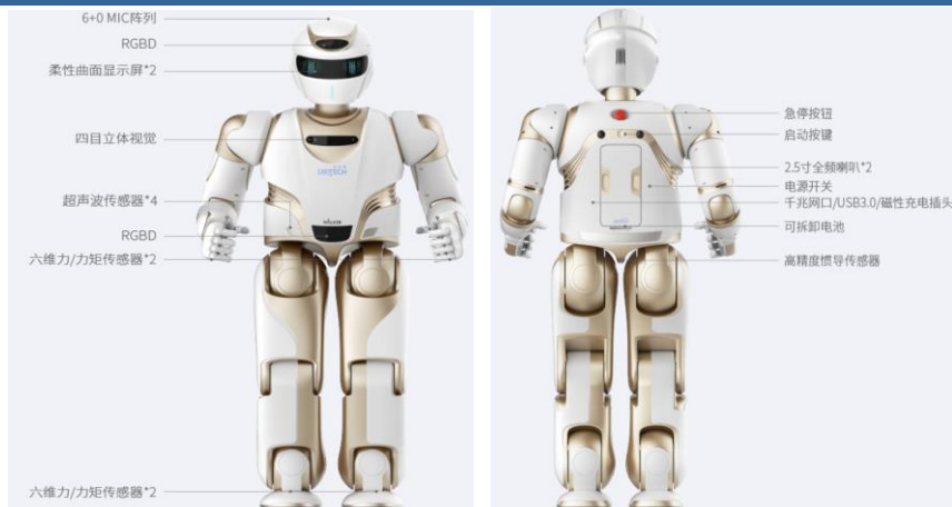
图表27：六维力传感器在人形机器人的布局示意图
