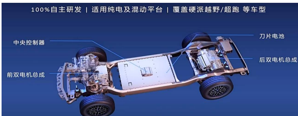
图表26 “易四方”的四电机平台独立驱动架构
