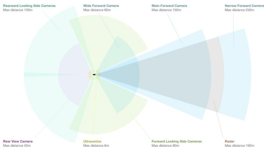
图表 42 HW 3.0 超声波传感器、雷达和摄像头
