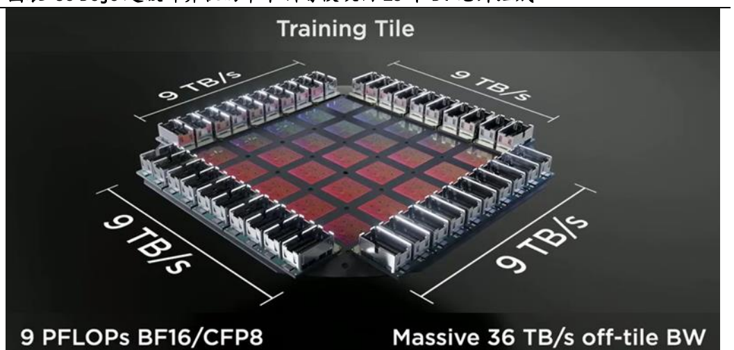
图表 53 Dojo 超级计算机的单个训练模块由 25 个 D1 芯片组成
