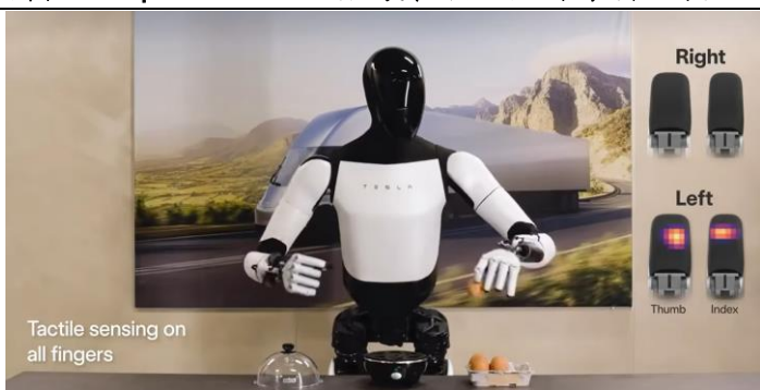
图表 89 Optimus Gen 2 抓鸡蛋（右侧显示手指压力）
