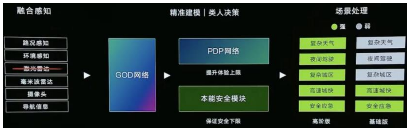
图表24 华为 ADS 基础版架构与华为 ADS 高阶智驾同源
