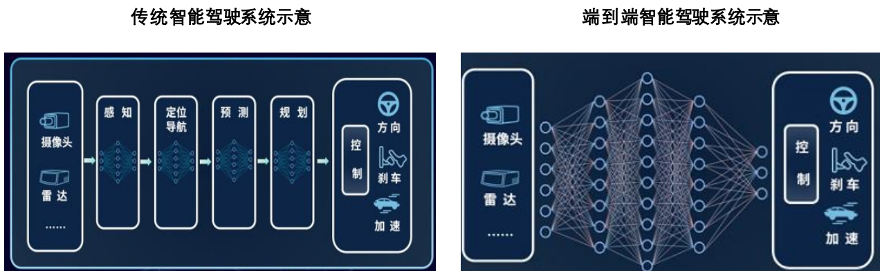
图表 15 端到端智能驾驶系统与传统自动驾驶系统技术架构对比
