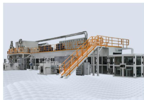
图 5：恒昌机械成人纸尿裤设备生产速度最高可达 500PPM
