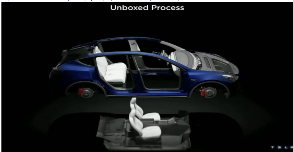
图14：unboxed 组装技术，将有效降低整车制造成本
