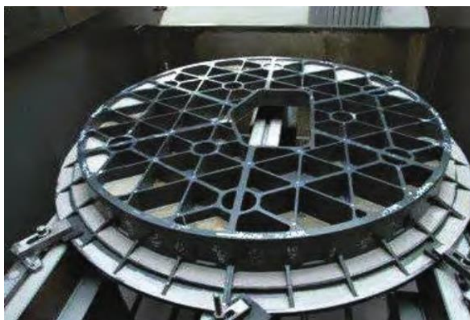
图16 德国和日本采用 C/SiC 复合材料共同研制的适合于 3.5m 口径空间相机的主反射镜
