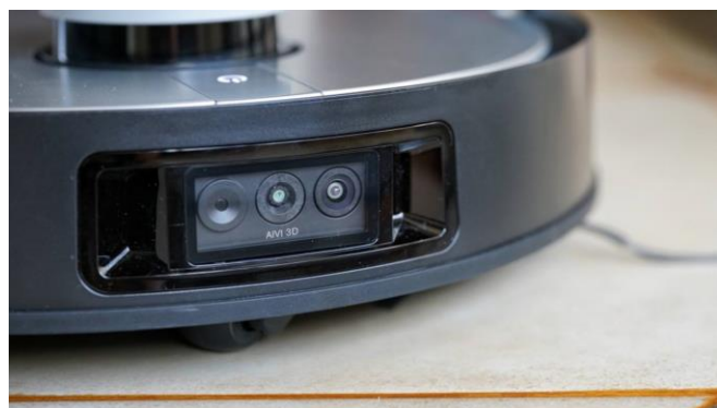
图表27: X1 OMNI 的摄像头+3D 结构光避障方案较领先
