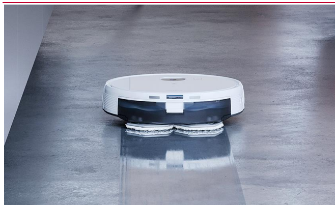
图表25: 科沃斯 N9+机身携带 220ml 电控水箱
