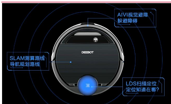
图表18：科沃斯 DG70 首次搭载 AIVI 视觉识别传感器
