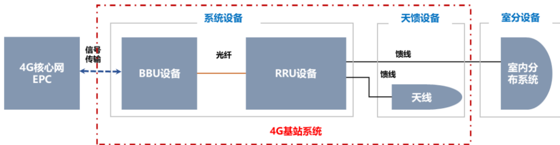
图7：移动通信接入网设备构成
