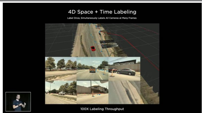
图59：在 BEV 空间下进行 4D 自动标注
