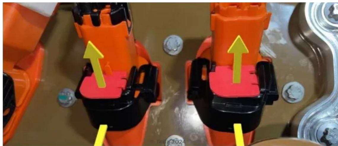
Cybertruck的电池组中感应式充电器接口
