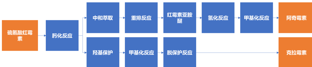
图 16：公司阿奇霉素及克拉霉素生产工艺流程
