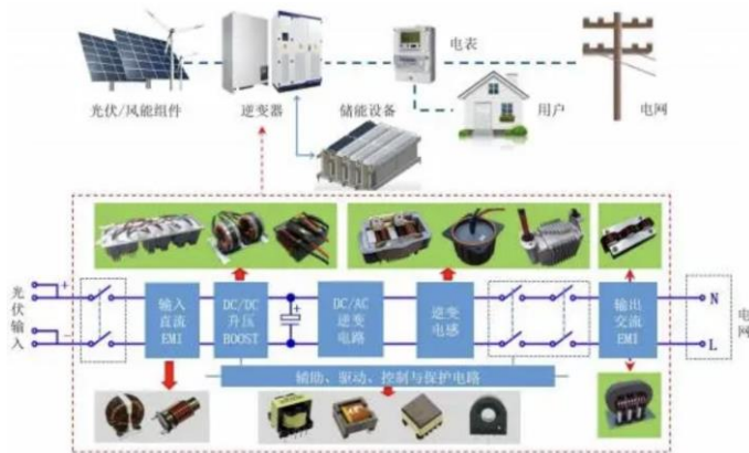
图 10: 光储系统中磁性元件的应用
