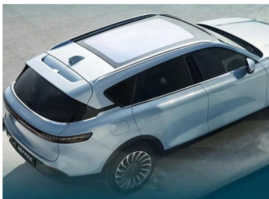
图20: 岚图 FREE PDLC 调光+镀膜隔热全景天幕
