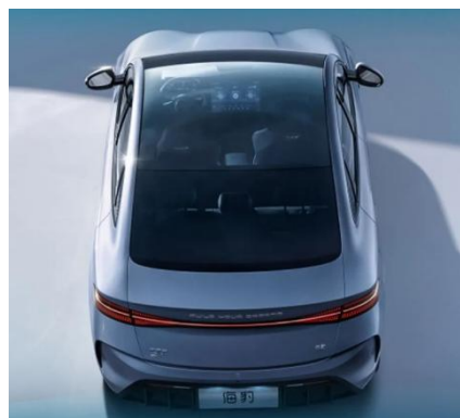
图21: 比亚迪海豹搭载 EC 调光+LOW-E 全景天幕
