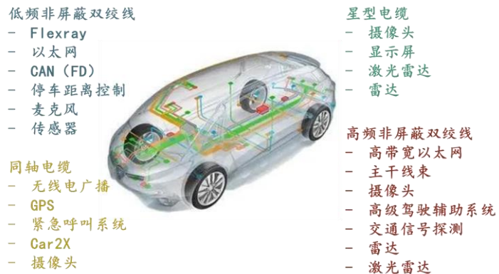
图 19: 车载以太网使用非屏蔽双绞线电缆
