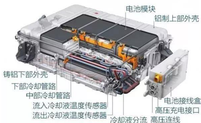
图12：新能源汽车的动力电池包冷却系统
