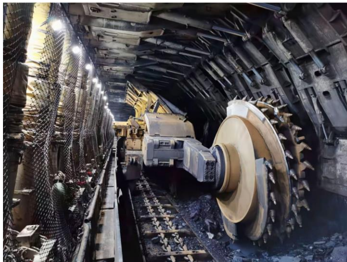
图 29：典型煤炭综采工作面结构
