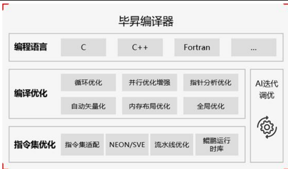
图12：毕昇编译器可融合编译，释放算力最大性能
