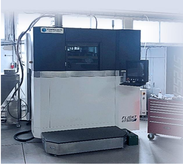
图65: 华曙高科定制化大幅面超高温粉末床烧结设备
