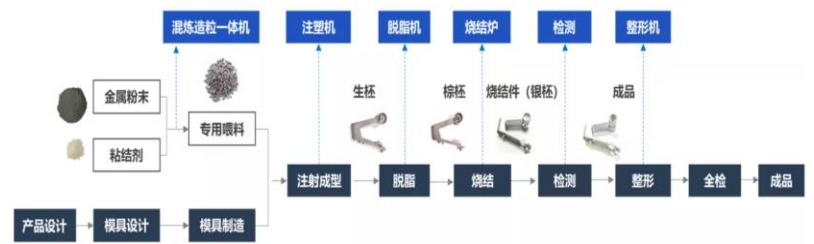
图54: MIM 工艺流程
