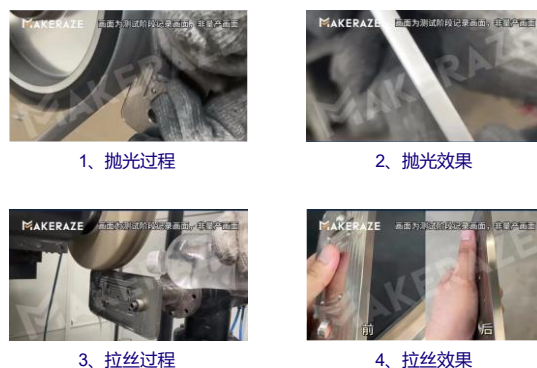
图50: iPhone 15 Pro 钛合金中框表面处理流程
