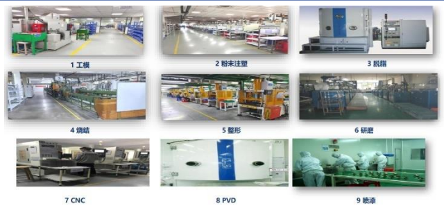
图33：MIM 工艺流程
