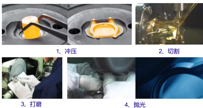
图49: 钛合金表框表面处理流程
