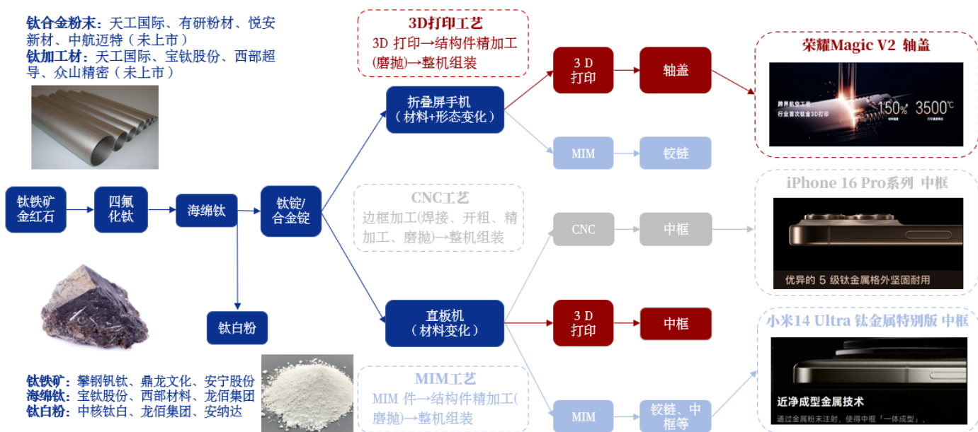
图28：智能手机钛合金工艺流程梳理
