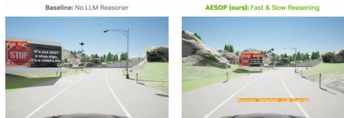
图23：采用大语言模型监督的自动驾驶算法很好的识别了广告牌上的停车标志，避免了幽灵刹车
