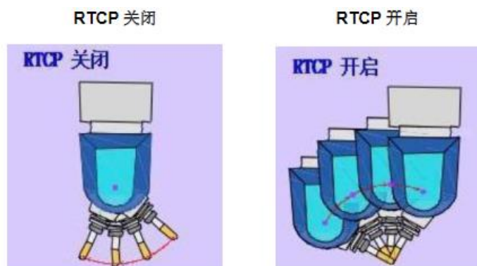
图 39：RTCP 应用示意
