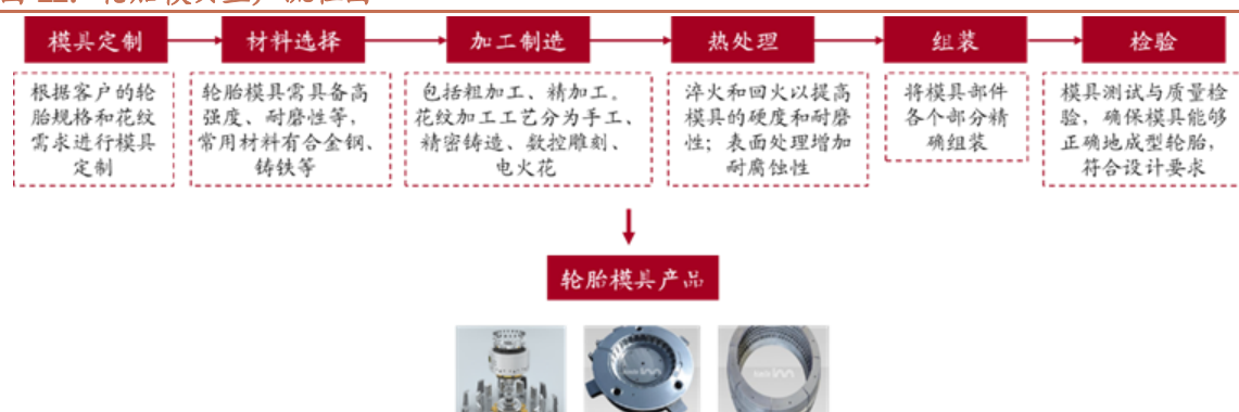
图 11：轮胎模具生产流程图
