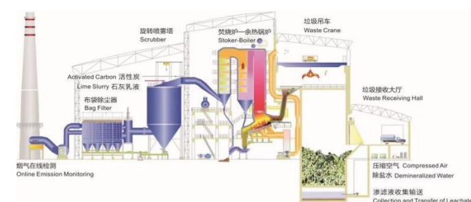
图33：引进德国马丁 SITY2000 焚烧炉技术
