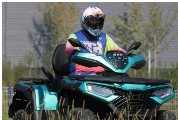
图36：公司于行业率先研发的搭载氢燃料电池全地形车
