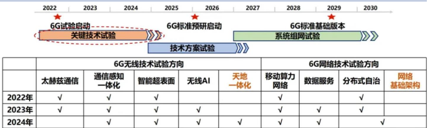
图6: IMT-2030(6G)推进组启动 6G 技术试验，分关键技术试验、技术方案试验、系统组网试验三个阶段
