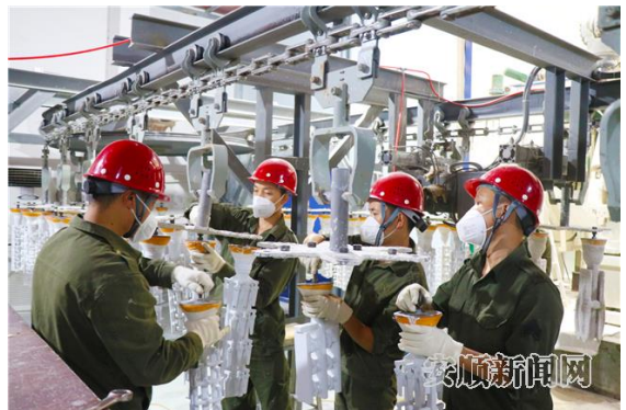
图表17: 安吉精铸公司工人正在进行制壳作业
