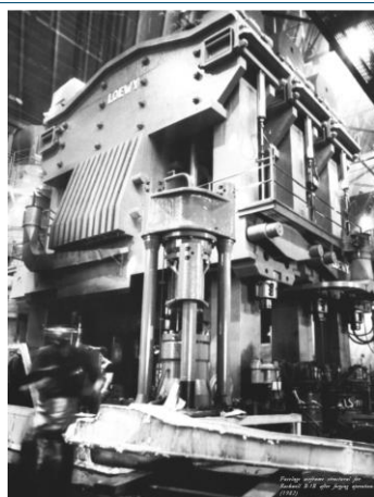
图表20: Wyman-Gordon 5万吨压机生产 B-1B 锻造后机身结构
