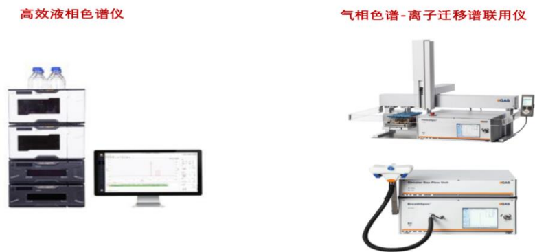
图16：色谱仪按照依据的色谱法可以分为液相色谱仪与气相色谱仪等
