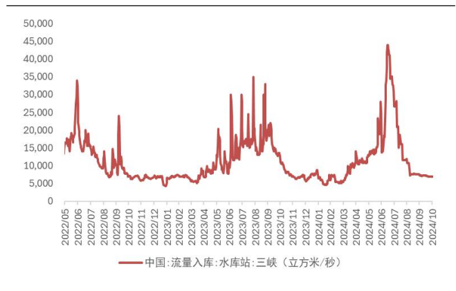
图 24：三峡水库站入库流量
