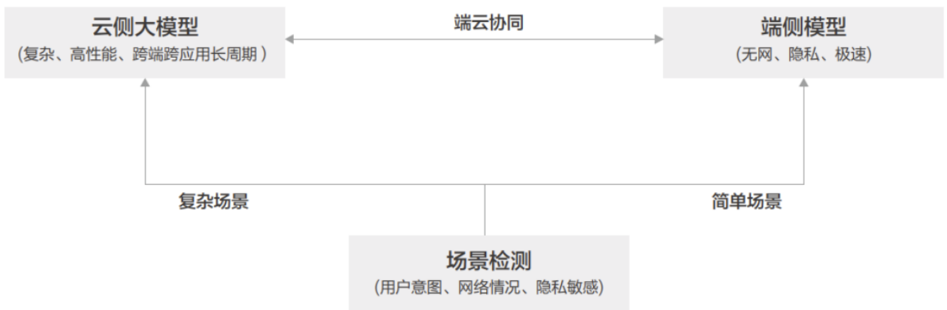
图16：端云结合模式提升端侧AI应用能力
