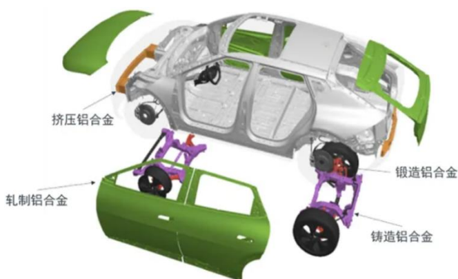
图17: 汽车用铝合金材料的应用位置分布
