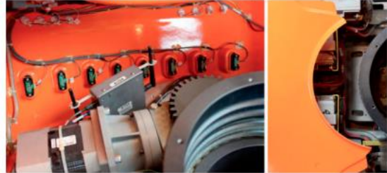
图2 前壳内部红外传感器组、后壳顶部视图
