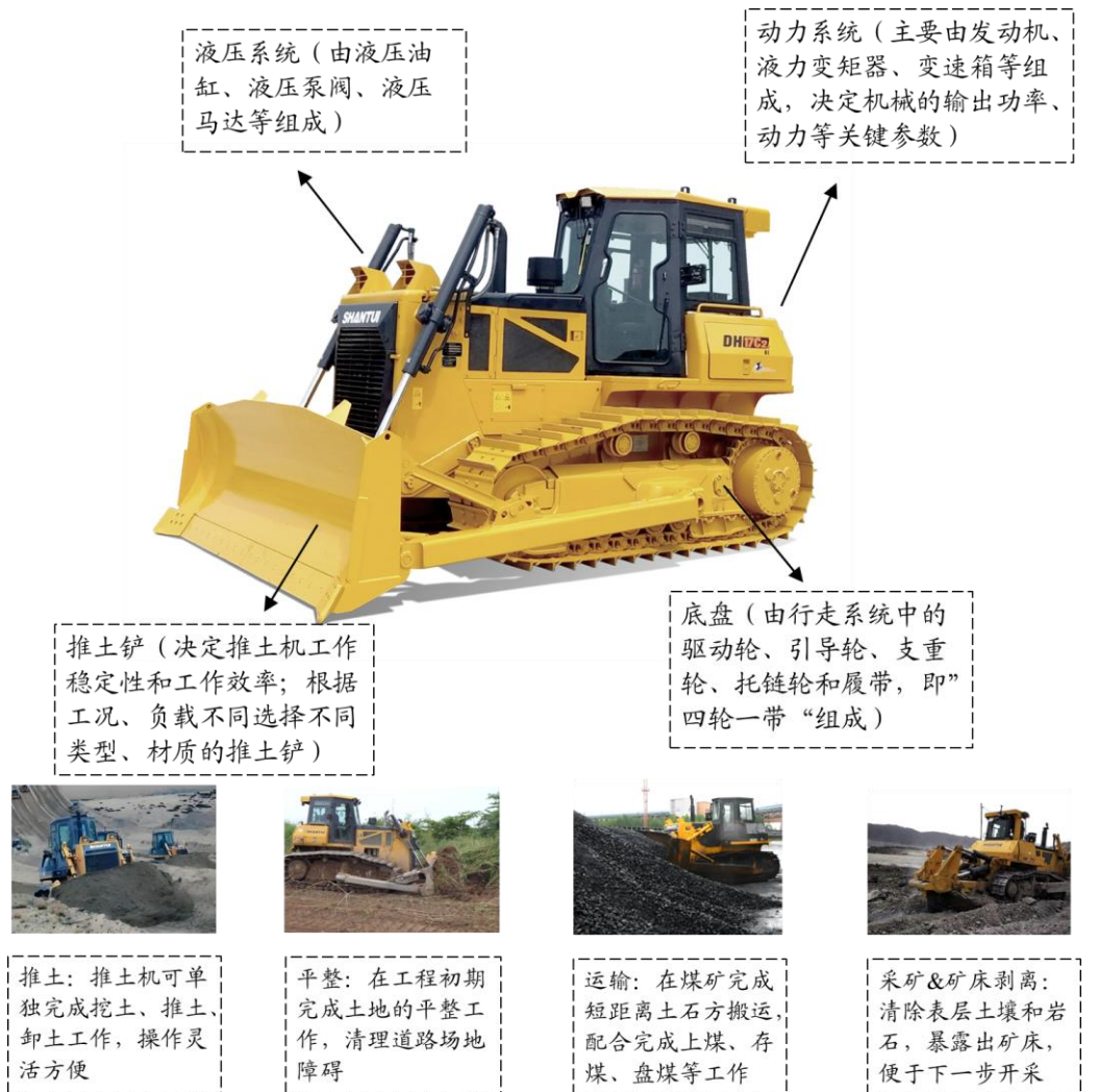
图14：推土机主要结构及使用场景
