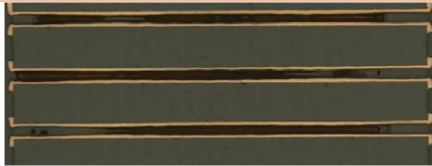
图 26：公司自研长径比高达 33 微钻测试图
