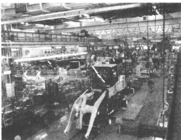
在小松栗津工厂进行的“混流生产”, 即把大小、零部件数目完全不同的轮式装载机和自动平地机放在一条生产线上进行组装。(2010年10月拍摄)
