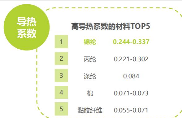
图49: 高导热系数的防晒服材料 (单位: W/(m \cdot ^\circ C) )
