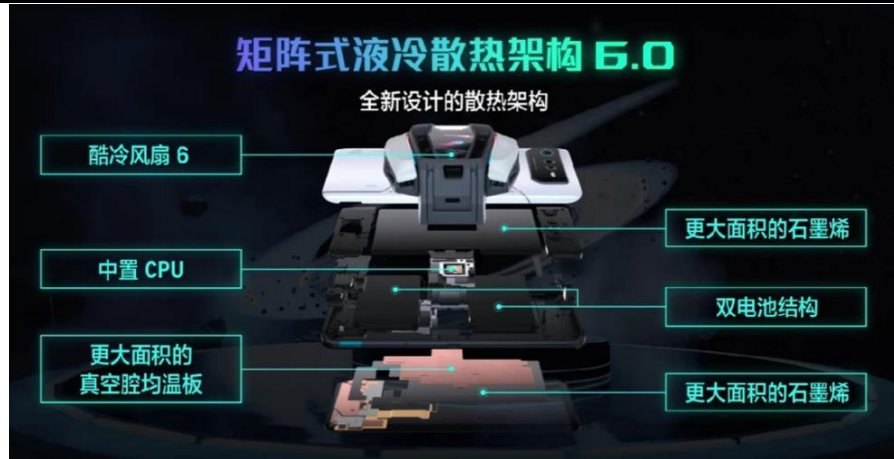
图 40：腾讯 ROG 游戏手机 6 系列矩阵式液冷散热架构示意图
