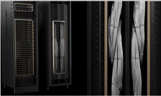
图 28: GB200 NVL72 内部采用 5000 根 NVLink 铜缆
