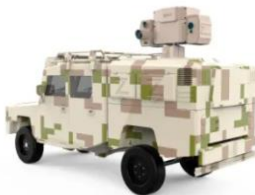
图20：光刃-II型系列激光反制系统
