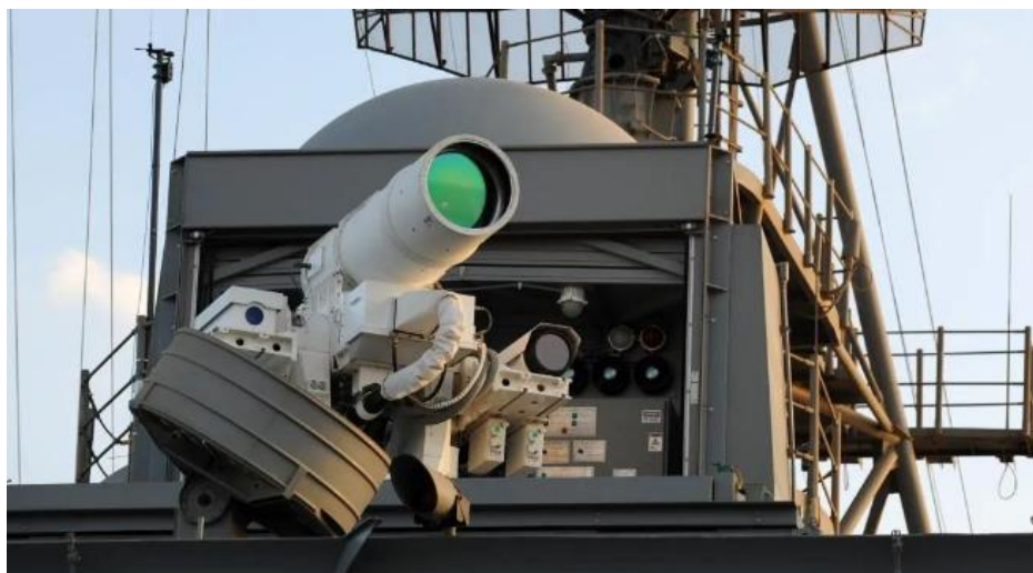
图7：美国海军“庞塞”号搭载的 30 千瓦级激光武器系统
