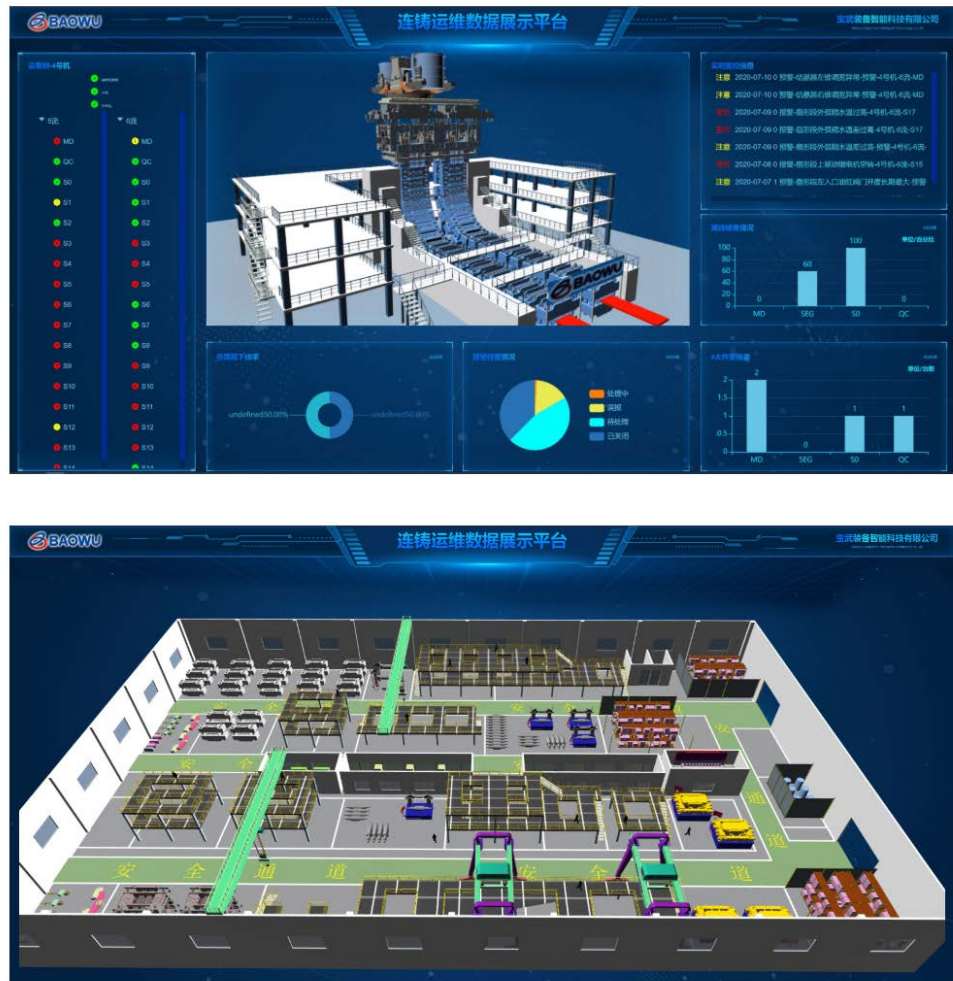
图 17：连铸区域设备远程智能运维
