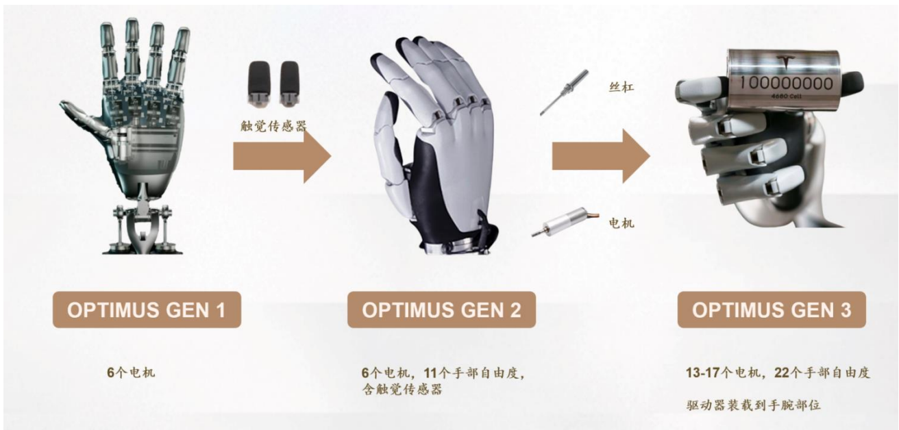
图表28: 特斯拉灵巧手自由度有提升趋势
