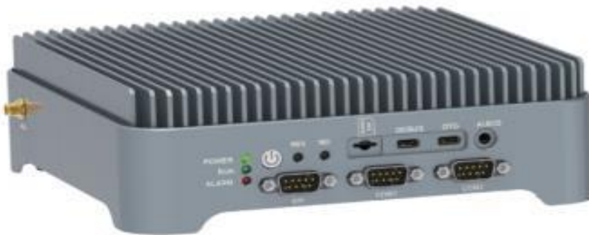
图16：边缘计算单元实时处理雷达、视频等设备的多源感知数据
