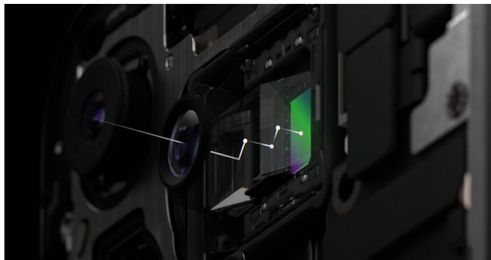
图 20：苹果 iPhone 15 Pro Max 配备潜望式镜头
