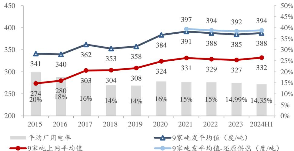
图：9家垃圾焚烧上市企业吨发电量 (度/吨)
