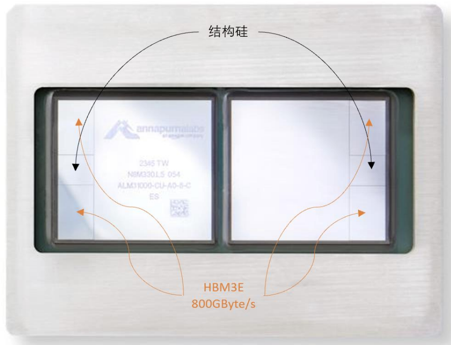
图表4: Trainium2 结构示意图
