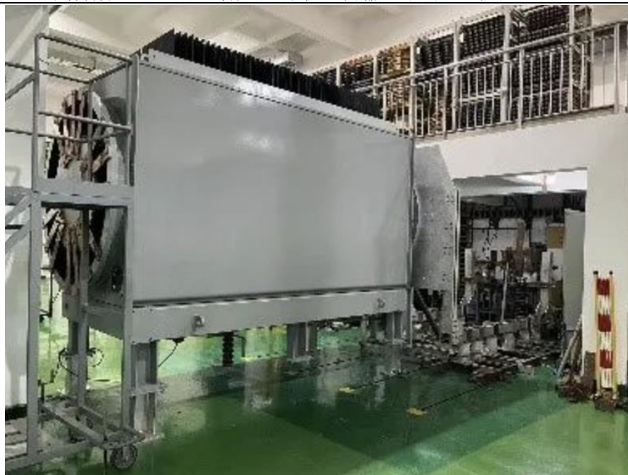
图 30：国际首台 31.5kV/210kA 环保型发电机快速断路器已经完成全套试验验证
