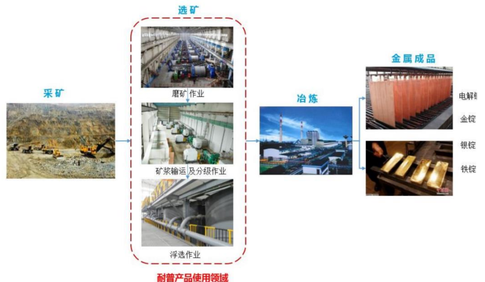
图2： 公司产品应用于选矿流程中的磨矿分级和选别作业
