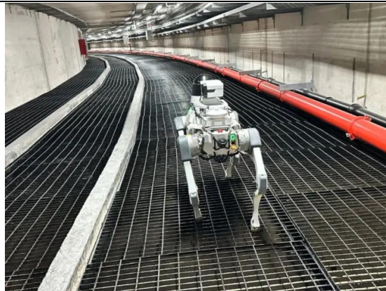
图4：新加坡能源集团将云深处的四足机器人用于电力管廊巡检中
