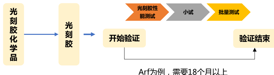
图 20：光刻胶产业化流程
