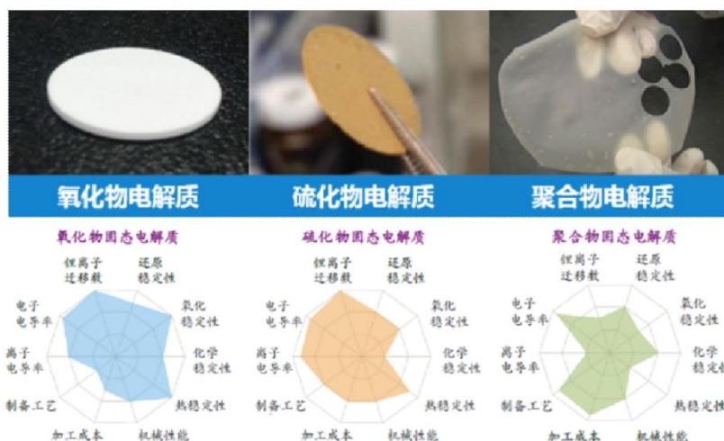
图表11: 三种固态电解质实物及性能对比
